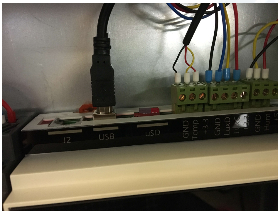
شکل ۱۰ محل اتصال حافظه جانبی و کابل USB جهت تنظیمات
