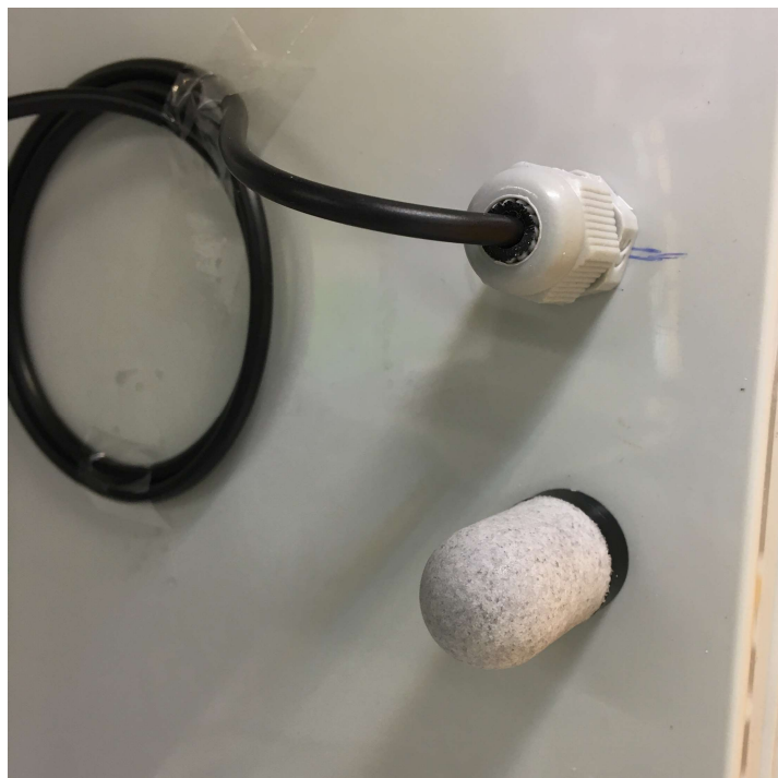
شکل ۹ غلاف حسگر رطوبت و سیم افزاینده حسگر دما، خارج از جعبه
