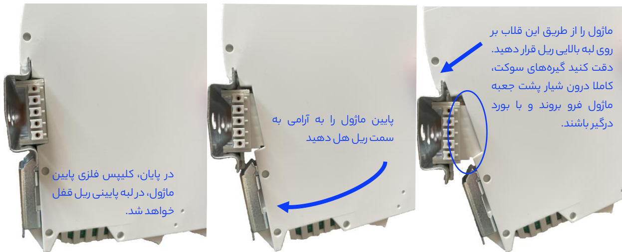
شکل ۹ نحوه قرار دادن ماژول بر روی سوکت‌های گذرگاه موازی
