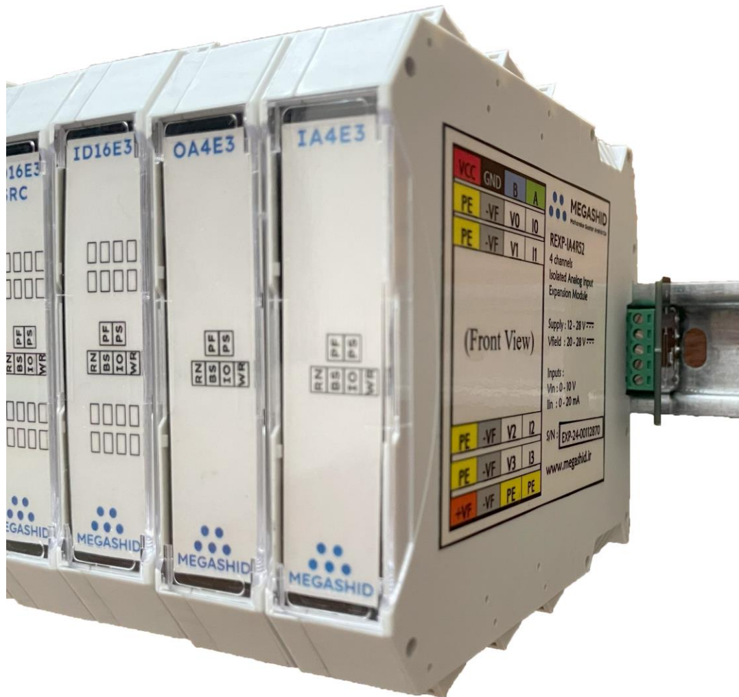
شکل ۱۱ نصب ماژول MTR22 و ماژول های گسترش بر روی ریل، نمای سمت راست + بورد انتهای گذرگاه موازی
