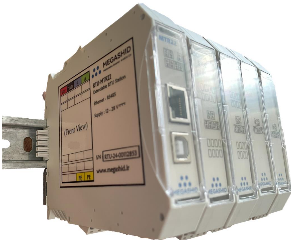
شکل ۶ نصب ماژول MTR22 و ماژول‌های گسترش بر روی ریل، نمای سمت چپ
