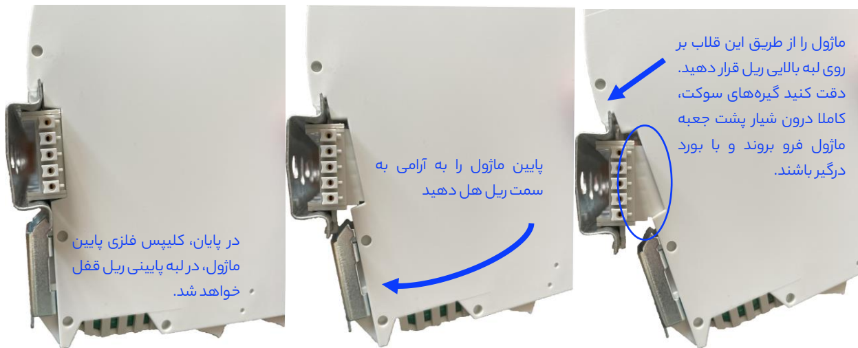
شکل ۵ نحوه قرار دادن ماژول بر روی سوکت‌های گذرگاه موازی
