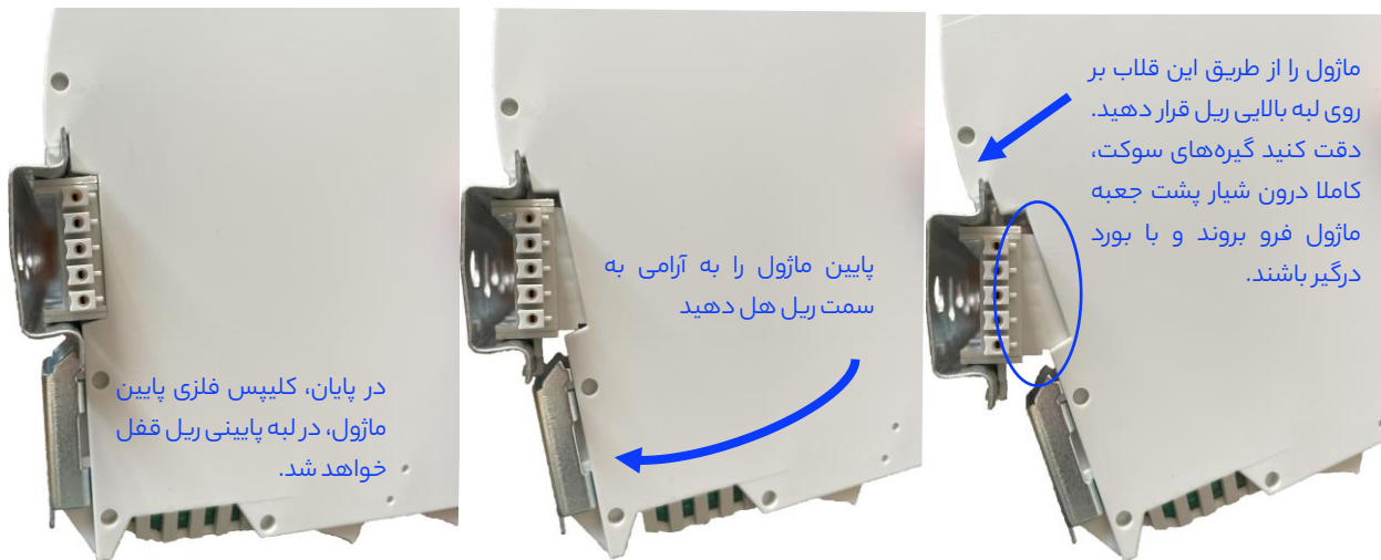
شکل ۷ نحوه قرار دادن ماژول بر روی سوکت‌های گذرگاه موازی
