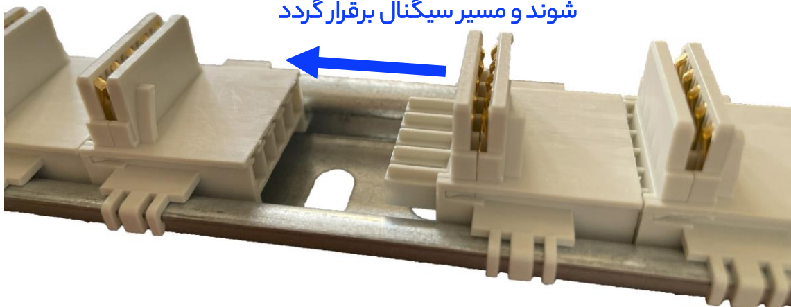
شکل ۵ نحوه اتصال سوکت‌های گذرگاه موازی درون یکدیگر
